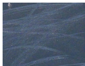
à gauche: rayures blanches sur un enduit mat à droite: traces brillantes dues au lustrage
